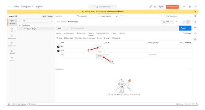
7. После выбора типа «File» в колонке «VALUE» появляется кнопка «Select Files», при нажатии на которую необходимо выбрать файлы для тестирования выбранного режима работы (перечисленные в главе 2.1 - Список тестов). На изображении приводится пример выбора файлов для генерации одиночного отчёта.
